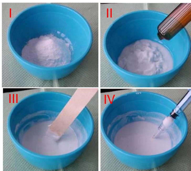
Рисунок 1.3.1.1. – Схема приготовления КФЦ
