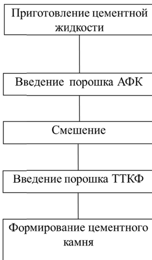
Рисунок 3.6. – Схема получения композиционного КФЦ
